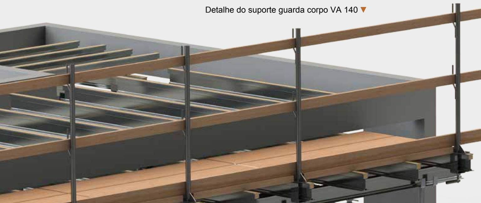
Encaixar o suporte de guarda corpo na viga.
